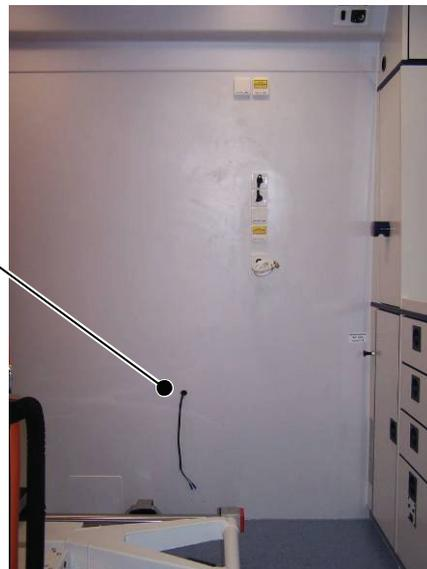
**Hinweis** Diese 12V Spannungsvorrichtung wird nur mit Spannung versorgt, wenn der Motor vom Fahrzeug gestartet ist oder die 230V Außeneinspeisung eingesteckt ist und das Batterieladegerät läuft.
