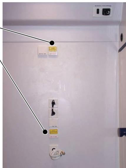
**Achtung!** Die Steckdosen dürfen nur verwendet werden zum Betrieb elektrischer Geräte im Fahrzeug. Bei Verwendung außerhalb des Fahrzeuges ist eine Absicherung durch den Fehlerstromschutzschalter nicht mehr gegeben.
