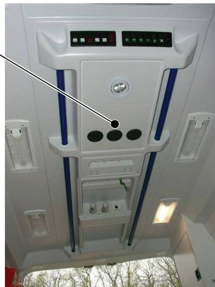
Die Düsen können einzeln geschlossen und geöffnet werden und um 360° gedreht werden.
