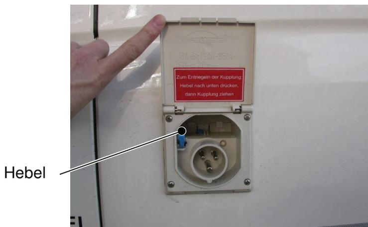
Sobald die Einspeiseleitung in die Außeneinspeisesteckdose eingesteckt wird, wird eine Startsperrung für den Fahrzeugmotor aktiviert. Die Aktivierung der Startsperrung wird signalisiert durch einen dauerhaften Summton, sobald der Zündschlüssel in der Stellung „Zündung“ gedreht wird.
