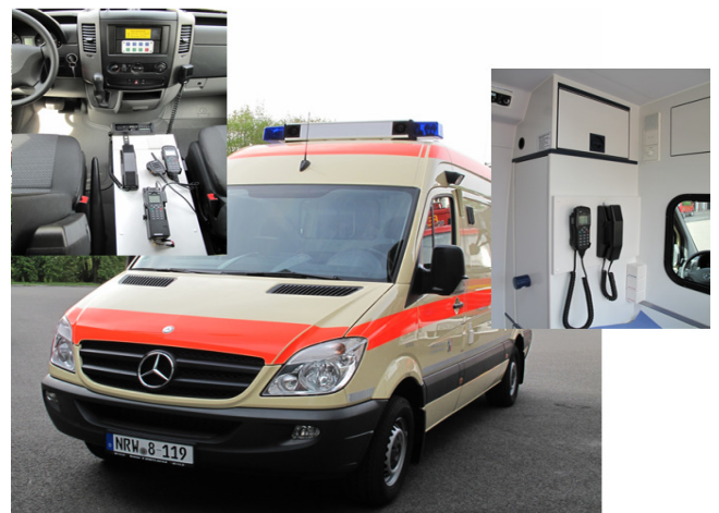
Abb.: IdF NRW KTW-B mit Funkbedienmöglichkeit Fahrerkabine (li.) und Patientenraum (re.)
