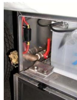
Bild 7: Kugelhahn zur Tankentleerung
